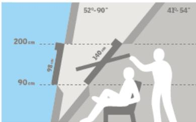
La finestra con apertura a bilico rende possibile il posizionamento di arredi al di sotto della finestra senza comprometterne l'operabilità.
